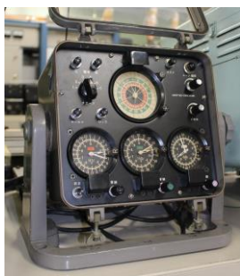
写真6 船舶用デッカ受信機 MS-1A型指示部 (電気通信大学UECミュージアム所蔵)
