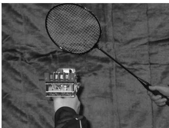
〈写真1〉 バドミントン用ラケットの素振り速度を測定中の本機
