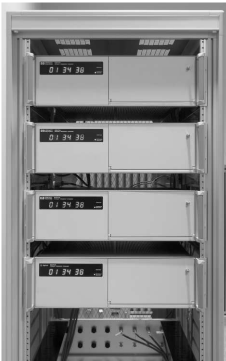
〈写真2〉 日本標準時を作るセシウム原子時計 (Symmetricom社5071A)
