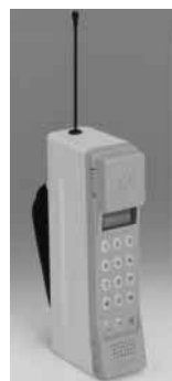
〈写真2〉 最初の携帯電話(TZ-802B, 出力1W, 容積 997cc, 0.9kg, 1987年, NTT)
