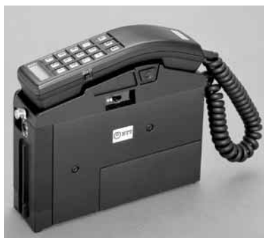
〈写真1〉 ショルダーホン 100型 (TZ-802, 出力5W, 容積 1500cc, 3kg, 1985年, NTT)
