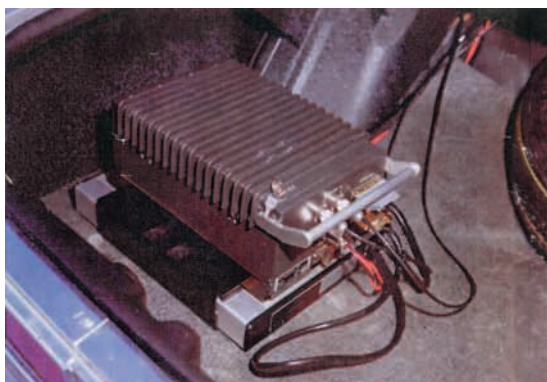
〈写真1〉米国のシカゴ・トライアルに使われた自動車電話実験機(1977年, 沖電気)
