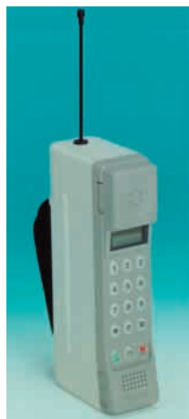
〈写真3〉 最初の携帯電話(TZ-802B, 出力1W, 容積997cc, 0.9kg, 1987年, NTT)
