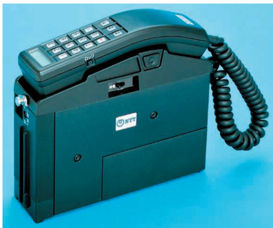
〈写真2〉ショルダーホン100型(TZ-802, 出力5W, 容積1500cc, 3kg, 1985年, NTT)
