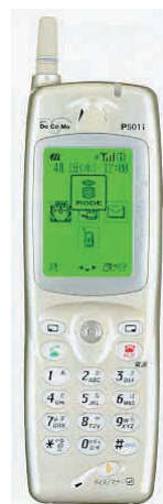
〈写真4〉 最初のiモード端末の一例 [P501i, 容積91 cc, 89 g, 出力0.8 W, 松下通信工業(当時)]
