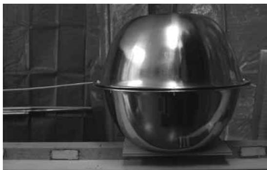
〈写真3〉 送波器アンテナ端に金属球を取り付ける
