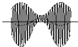
図6-7 C1が大きいときのコレクタ電流
