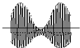
図6-6 C1が大きいときの電流
