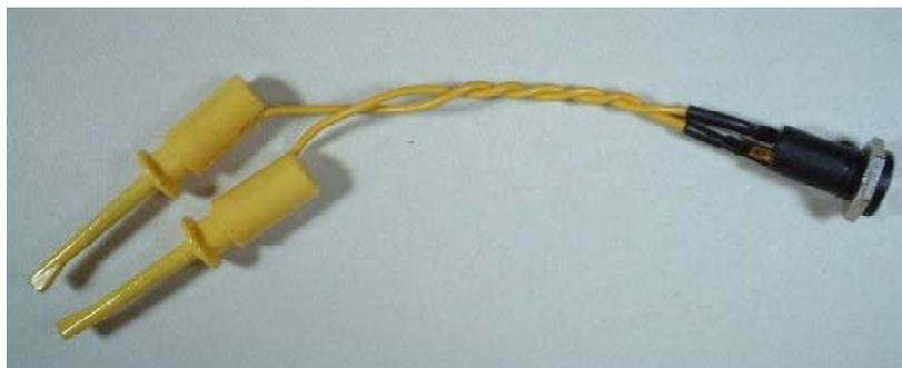
写真5-2 イヤホンジャックとICクリップをつないだもの
