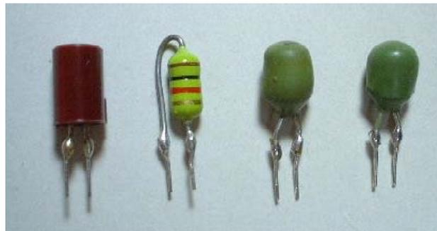
写真5-3 使用したコイル(右から0.82mH, 1mH, 2.2mH, 3.9mH)
