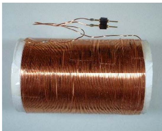
写真1-5 製作した空芯コイル
