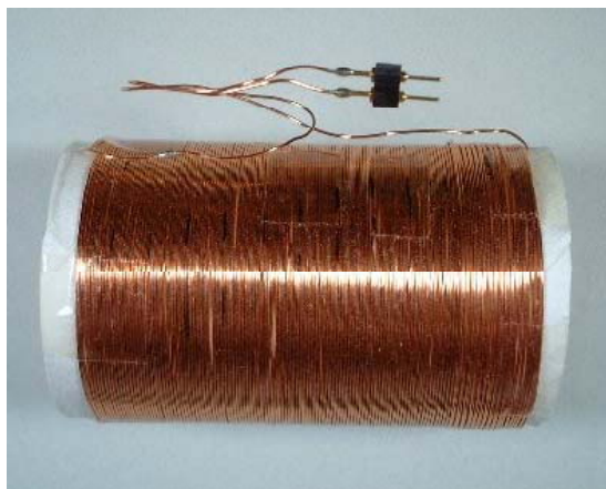
写真1-5 製作した空芯コイル
