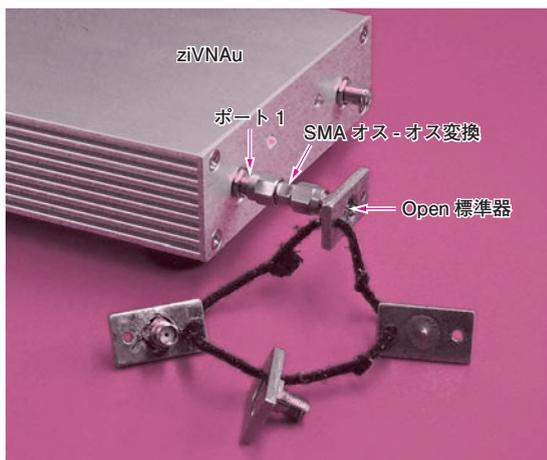
〈写真9.1〉Open標準器の $S_{11}$ を測定するようす
