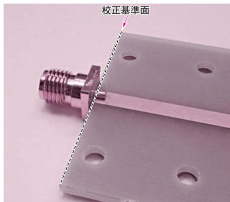
〈写真8.6〉校正基準面は基板端
