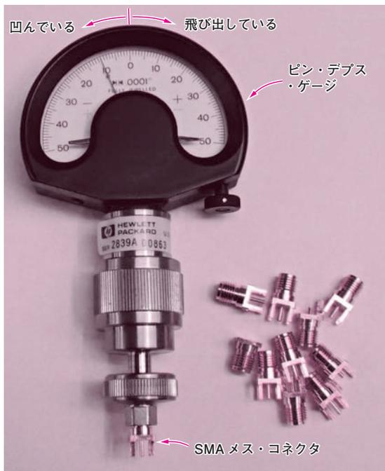
〈写真8.2〉ピン・デプスを測定するゲージ
