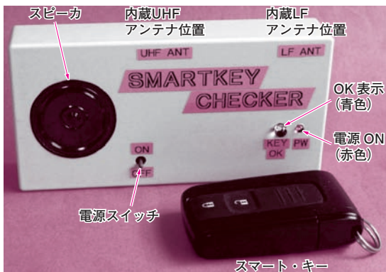
〈写真1〉製作したスマート・キー・チェッカの外観
