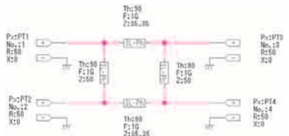
(図3.5) S-NAPの回路図エディタで作成した90°ハイブリッド回路
