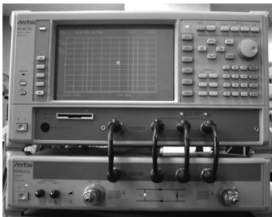
〈写真3〉仕事で使っているアンリツのネットワーク・アナライザ MS4670C + MS8602A(100 kHz ~ 8.5 GHz)
