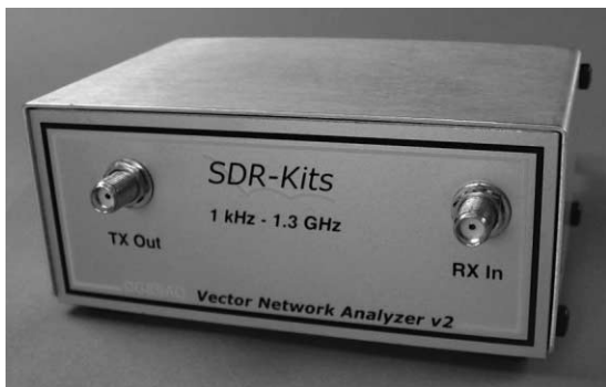
〈写真1〉手のひらサイズのベクトル・ネットワーク・アナライザ・キット“VNWA2.1”の外観
