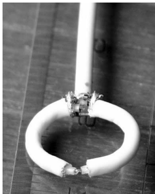
〈写真2〉 製作したループ・アンテナ
