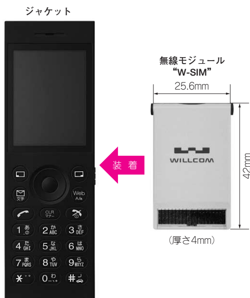
〈図4〉 W-SIMによるPHS端末機の実現
