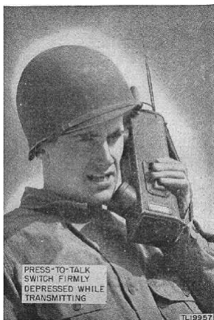
〈写真1〉最初の携帯無線機 SCR-536(AN/BC-611, 3.5~6 MHz, AM, 電池込み2.5 kg, 通信距離:陸上1.6 km, 海上4.8 km, 1940年, 米国 Galvin Manufacturing Corp.)
